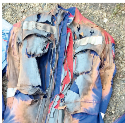
▲ Результаты испытания спецодежды электрической дугой
