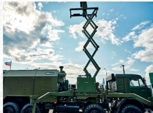
танный **НИИ «Вектор»**. В отличие от подобных систем комплекс работает не на принципах радиолокации, а совмещая тепловую и звуковую разведку, что делает невозможным его радиоэлектронное подавление.
