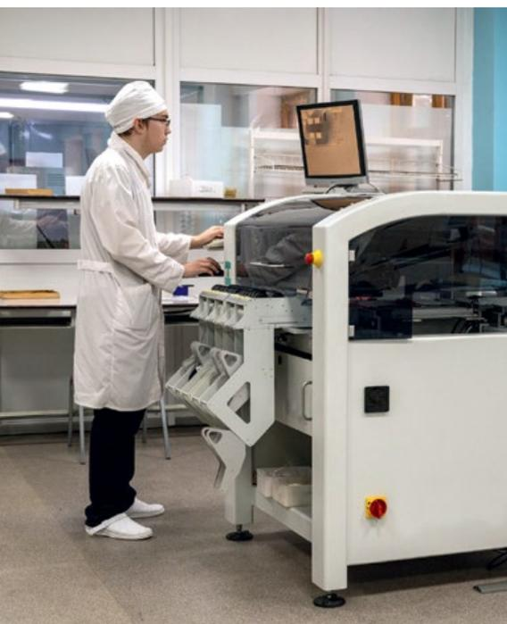
На данном этапе на новом участке появилось две единицы современного оборудования: установщик радиоэлементов и паяльная печь. Высокопроизводительная техника призвана облегчить труд монтажников радиоэлектронной аппаратуры и приборов, снизить трудоемкость и повысить качество производимой продукции.
